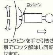
ロックピンを手で引き抜く事でロック解除し回転させます。
